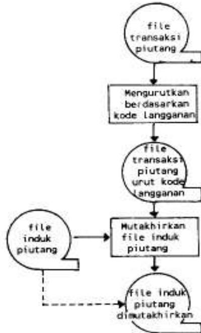
Gambar. Bagan alir sistem metode *batch processing*
